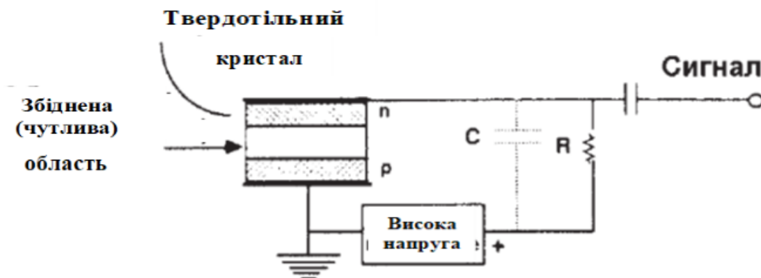
Рис. 6. Спрощена схема підключення напівпровідникового детектора ( n та p – області напівпровідникового кристала відповідно з електронною та дірковою провідністю; R – опір навантаження детектора, на якому виділяється корисний сигнал; C – еквівалентна ємність, що включає ємність детектора та паразитну ємність монтажу)
