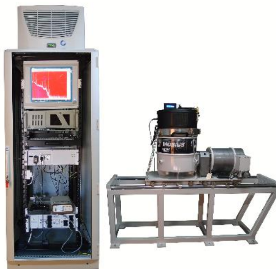
Рис. 40. Апаратно-програмний комплекс СТПК-01 для технологічного контролю активності реперних радіонуклідів ( ^{131}\text{I} – ^{135}\text{I} , ^{133}\text{Xe} , ^{135}\text{Xe} , ^{85\text{m}}\text{Kr} , ^{87}\text{Kr} , ^{88}\text{Kr} ) у теплоносії першого контуру ядерних реакторів ВВЕР-1000 за допомогою гамма-спектрометрії високої роздільної здатності.
