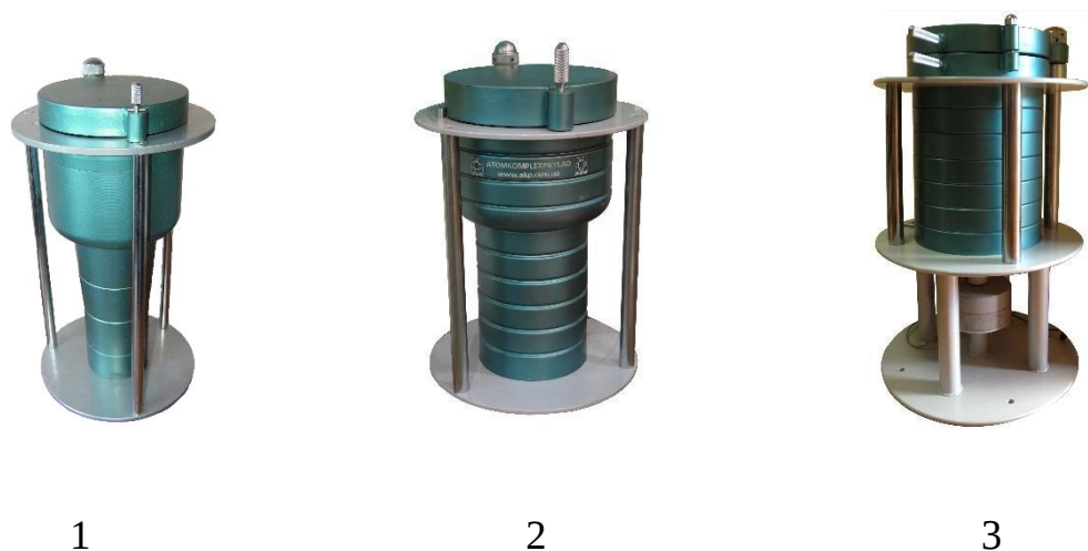
Рис. 44. Сцинтиляційний спектрометр гамма-випромінювання СЕГ-001 "АКП-С" різних модифікацій (1- СЕГ-01-«АКП»-40; 2 - СЕГ-01-«АКП»-63; 3- СЕГ-01-«АКП»-150)
