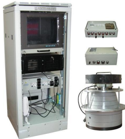
Рис. 41. Програмно-технічний комплекс "Азот-16-ПГ" для визначення протікання в парогенераторах енергоблоків ВВЕР-1000 за питомою активністю ^{16}\text{N} в гострій парі ПГ
