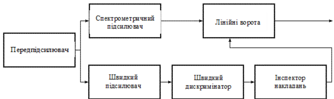
Рис. 21. Функціональна схема режекції накладань з використанням інспектора накладань [13]
